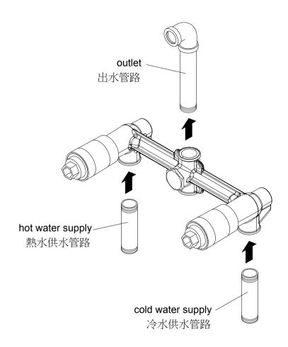
\* Install hot and cold water supply pipes and outlet. 依圖示,安裝冷熱供水管路,與出水管路。
